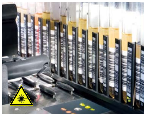
以样品管模式载入样本，轻轻滑入样品，1 秒内记录样本信息。
