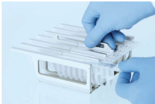
Joonis 9. Reaktiivikassettide aluse laadimine. Kassetalusel on nool, mis näitab, millises suunas reaktiivikassetid (RCB) tuleb paigaldada.
