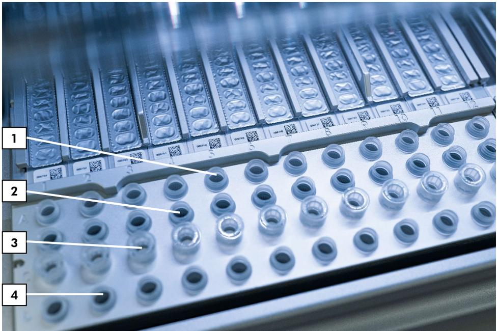
**Abbildung 5. Arbeitsplattform eines EZ2 Connect MDx Geräts.** (1) In Reihe A geladene Probenröhrchen (ST) (2 ml) (2) Leer oder optional: In Reihe B geladene Röhrchen (2 ml) mit 80 % Ethanol für optionalen Waschschritt. (3) In Reihe C geladene Einweg-Pipettenspitzenhalter (DTH) mit Einweg-Filterpipettenspitzen (DFT). (4) In Zeile D geladene Elutionsröhrchen (ET) (1,5 ml).
