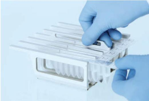
**Abbildung 9. Laden des Reagenzienkartuschenracks.** Das Kartuschenrack ist mit einem Pfeil markiert, der die Richtung anzeigt, in der die Reagenzienkartuschen (RCB) geladen werden müssen.
