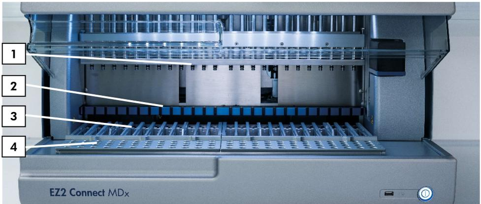
**Abbildung 4. Überblick über ein EZ2 Connect MDx Gerät.** (1) Pipettierkopf, (2) Magnetmodul, (3) Kartuschenrack und (4) Pipettenspitzenrack (Labormaterialhalter).
