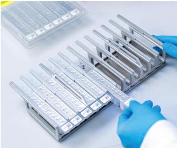
**Abbildung 3. Reagenzienkartuschenrack.** Das Kartuschenrack ist mit einem Pfeil markiert, der die Richtung anzeigt, in der die Reagenzienkartuschen (RCB) geladen werden müssen.
