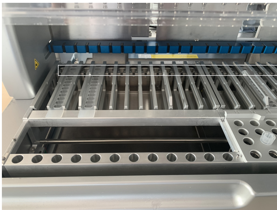
Joonis 17. Kassetaluse kuumutatavad kohad (tähistatud valge raamistusega).
