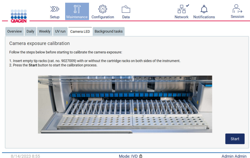
Joonis 29. Kaamera särituse kalibreerimise ekraanikuva.
