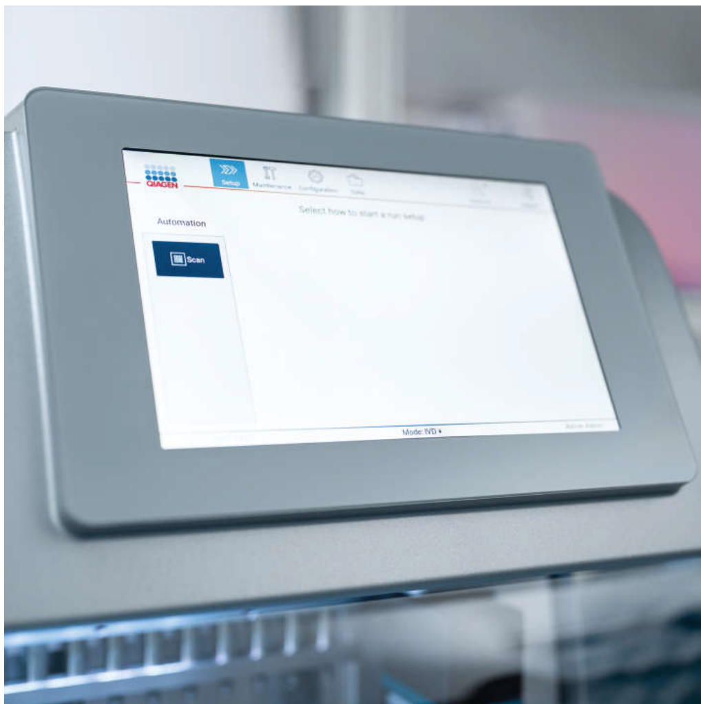
Joonis 3. EZ2 puutetundlik ekraan graafilise kasutajaliidesega.
