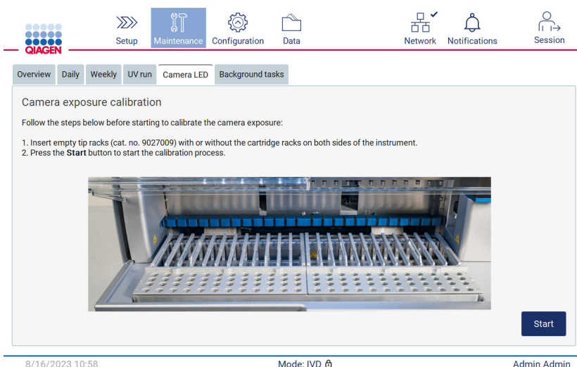
Joonis 191. Kaamera särituse kalibreerimise ekraanikuva.
