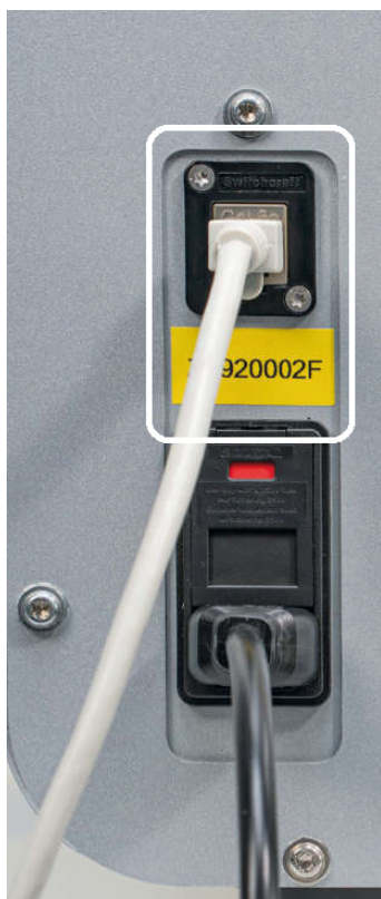
Joonis 6. RJ-45 porti asukoht (esile tõstetud valge raamistusega).
