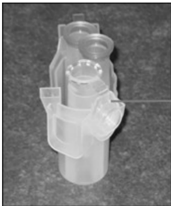
1.5 mL 微量離心管蓋子 位於轉子轉接器的錯誤 槽內
