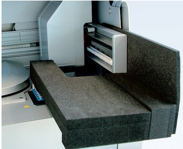
Miếng bọt xốp bảo vệ được đặt vào giữa máy ly tâm và cánh tay rô-bốt
