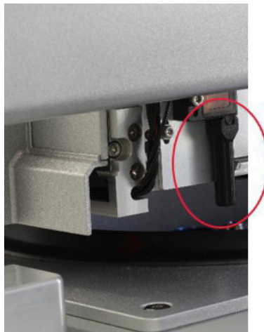
Bộ chuẩn trực chùm tia đen (xem vòng tròn màu đỏ) của cảm biến siêu âm.
