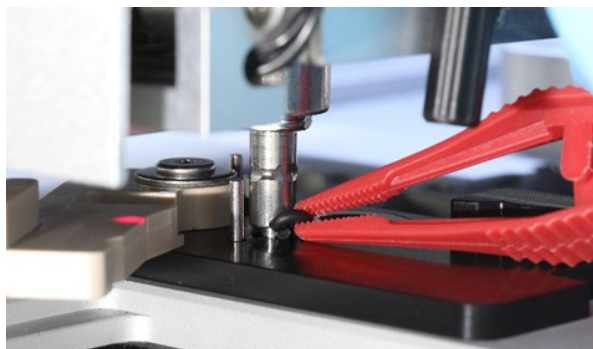
Mở cần màu xám và tháo Vòng chữ O bằng cách sử dụng nhíp.
