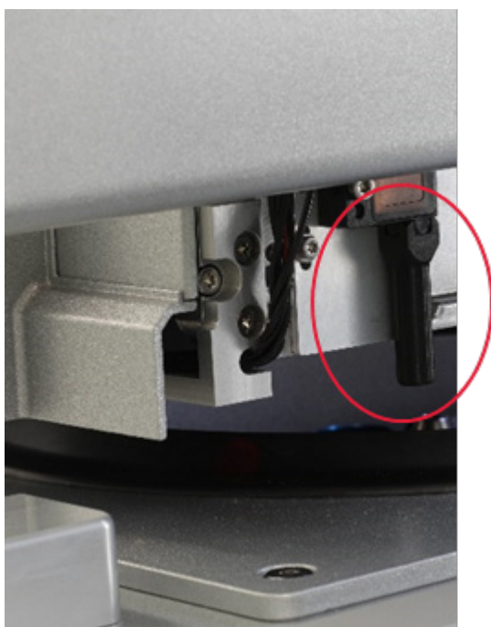
Colimador de feixe preto (ver círculo vermelho) do sensor ultrassónico.
