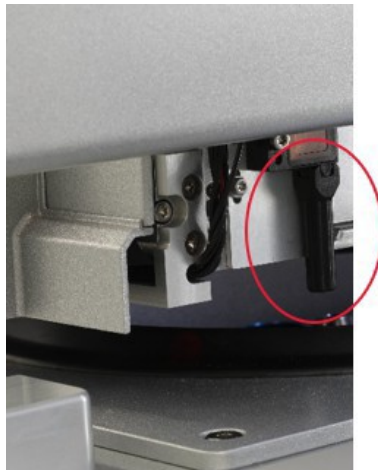
Colimador de feixe preto (ver círculo vermelho) do sensor ultrassônico.
