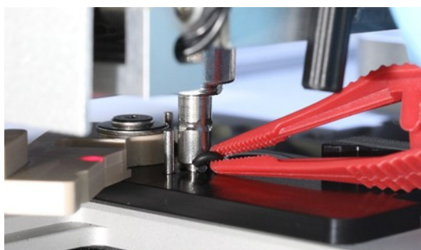
Abra a alavanca cinzenta e remova a anilha vedante utilizando a pinça.
