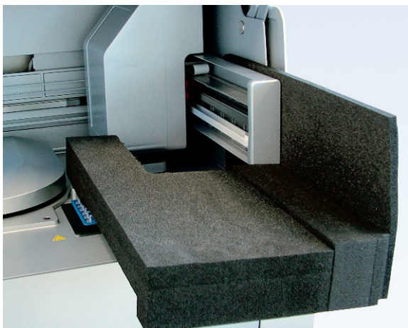
Роботтық қолдарға арналған көбік қорғаушысы.
