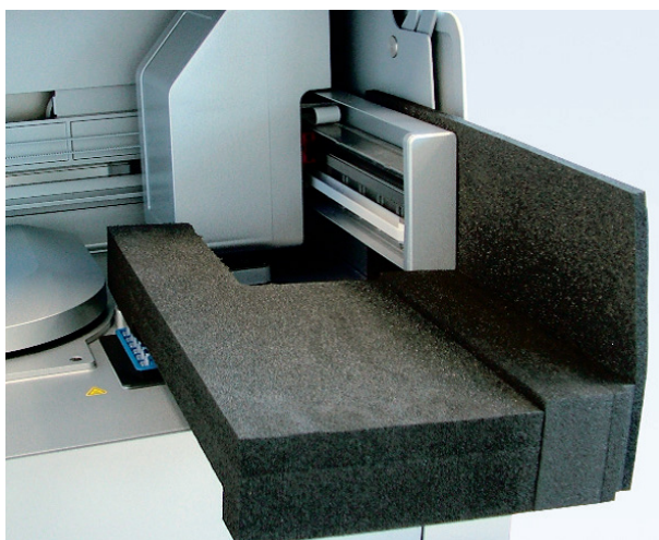
Центрифуга мен роботтық қолдың арасына көбіктен қорғағыш орнатылған.
