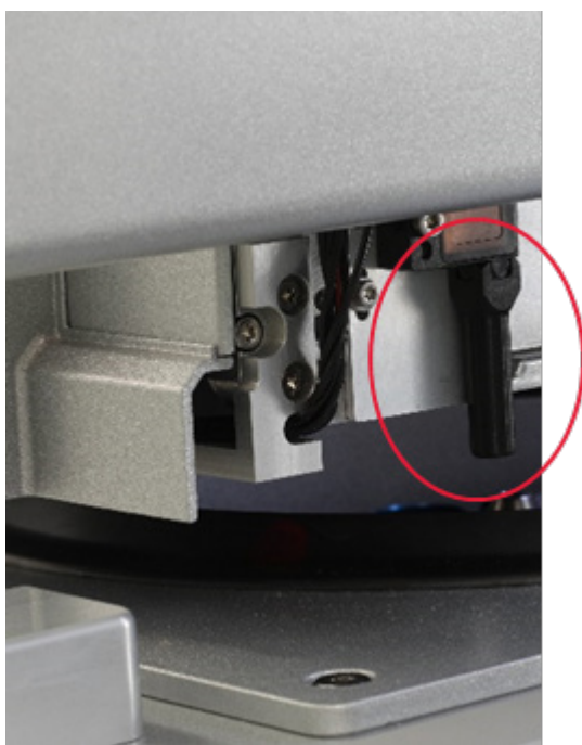
Ультрадыбыстық сенсордың қара сәулелік коллиматоры (қызыл шеңберді зерттейді).
