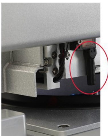
Ультрадыбыстық сенсордың қара сәулелік коллиматоры (қызыл шеңберді зерттейді).
