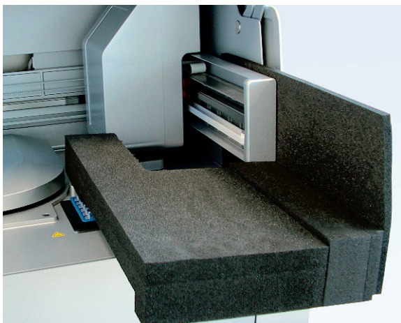
Mousse protectrice du bras robotisé.
