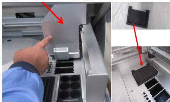
Protection en mousse sous les bras robotisés.
