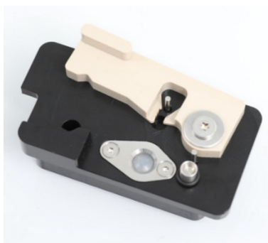
Outil de remplacement du joint torique avec nouveau joint torique préparé.
