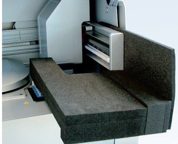
Mousse protectrice insérée entre la centrifugeuse et le bras robotisé.
