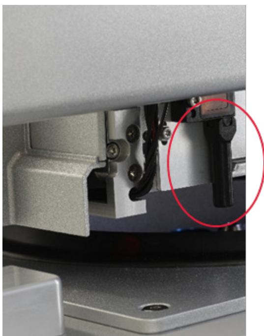
Collimateur de faisceau noir (dans le cercle rouge) du capteur ultrasonique.
