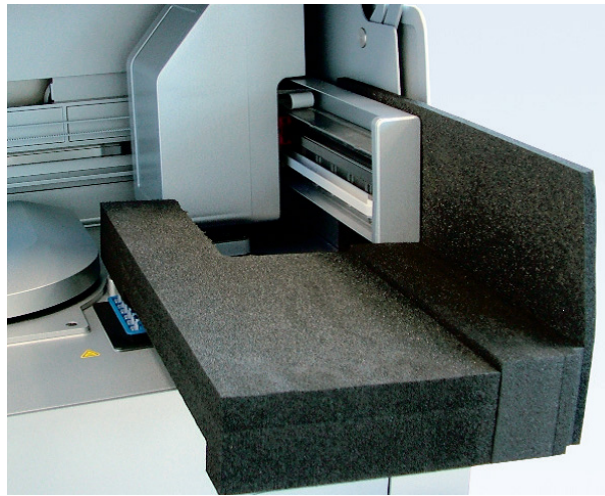
Protector de espuma insertado entre la centrifugadora y el brazo robótico.
