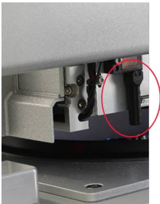
Colimador de haz negro (véase el círculo rojo) del sensor ultrasónico.
