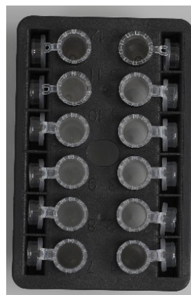
Prøverørens låg skal placeres sikkert i åbningerne ved kanten af rysterholderen.
