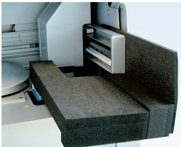
Skumbeskyttelse ilagt mellem centrifugen og robotarmen.
