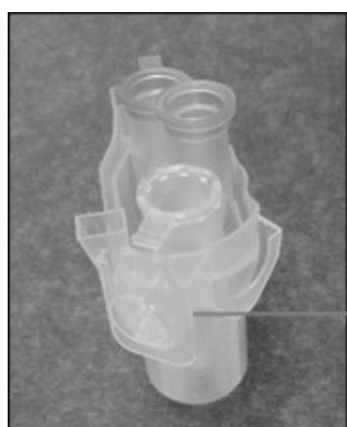
Správně nasazený adaptér rotoru. A Adaptér rotoru je správně nasazen a víčko 1,5ml mikrocentrifugační zkumavky je ve správné poloze. B Správně nasazený adaptér rotoru při pohledu z boku.
