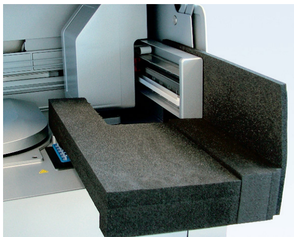
Ochranná pěnová vložka pro robotické rameno.
