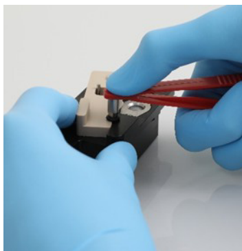
Zatlačení kolíku dolů s použitím druhého konce pinzety.
