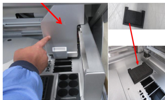
Ochranná pěnová vložka pod robotickými rameny.
