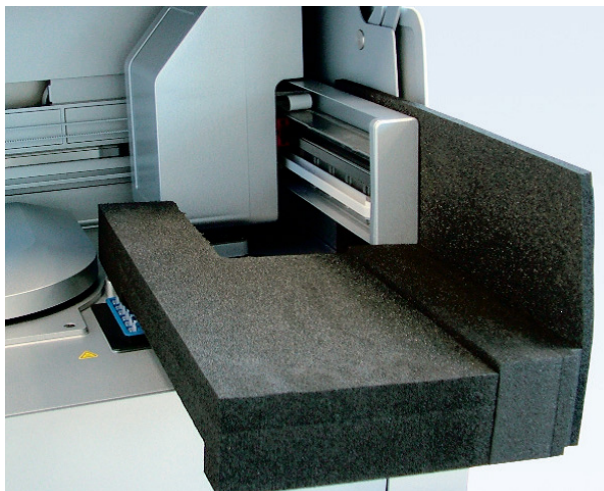
Ochranná pěnová vložka vložená mezi odstředivku a robotické rameno.
