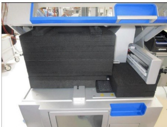
Pěnová ochranná vložka nad odstředivkou.
