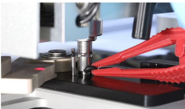
Otevření šedé páčky a vyjmutí o-kroužku pinzetou.
