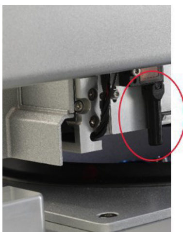
Černý kolimátor paprsku ultrazvukového senzoru (viz červený kruh).
