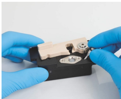
Zatlačení kolíku dolů s použitím druhého konce pinzety.
