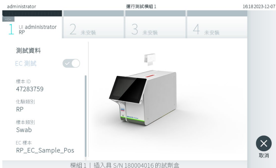
圖 97.將 QIAstat-Dx 檢測試劑匣插入 QIAstat-Dx Analyzer 2.0。
