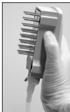
Figura 4. Ilustración de la herramienta de vacío levantada hasta más allá de la vertical de 90°.
