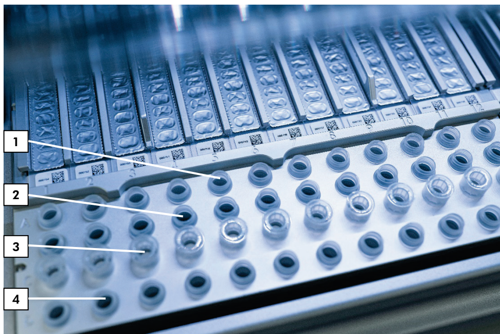
Figur 5. Arbejdsbord på et EZ2 Connect MDx-instrument. (1) Prøverør (ST) (2 ml), indsat i række A. (2) Tom eller valgfri: Rør (2 ml) indeholdende 80 % ethanol til valgfrit vasketrin, indsat i række B. (3) Éngangs filterspidsholdere (DTH), der indeholder éngangs filterspidser (DFT), indsat i række C. (4) Elueringsrør (ET) (1,5 ml), indsat i række D.
