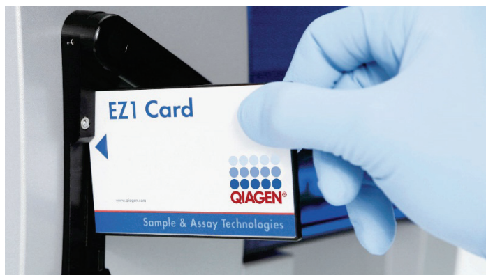
Figur 6. Nem protokolopsætning ved brug af EZ1 Advanced DSP-kort. Indsættelse af et EZ1-kort, der er forprogrammeret med protokollen, i EZ1-instrumentet.
