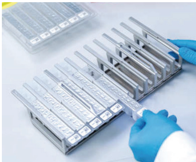
Figur 3. Reagenspatronstativ. Selve patronstativet er markeret med en pil for at vise den retning, reagenspatronerne (RCB) skal indsættes i.
