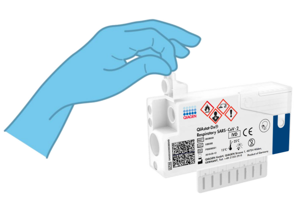
Figura 7. Abrindo a tampa de amostra da porta de swab.
