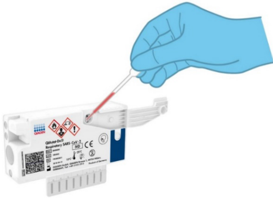
Figura 41. Transferindo a amostra para a porta principal do QIAstat-Dx Respiratory SARS-CoV-2 Panel Cartridge.
