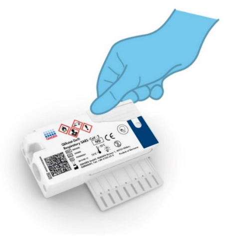
Figura 42. Fechando a tampa de amostra da porta principal.
