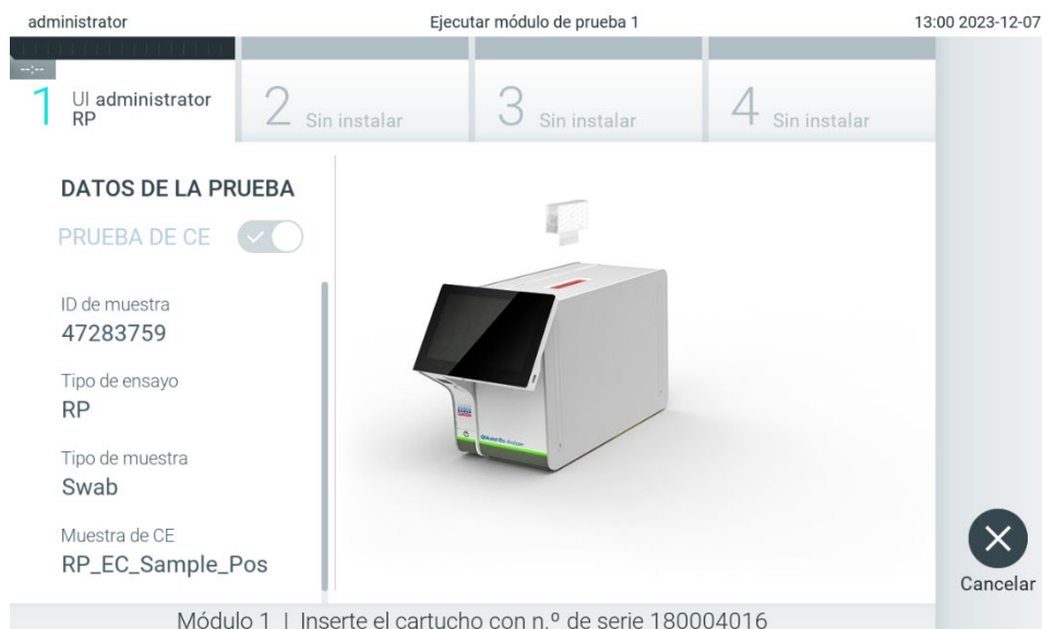
Figura 97. Introducción del cartucho de ensayo QIAstat-Dx en el QIAstat-Dx Analyzer 2.0.
