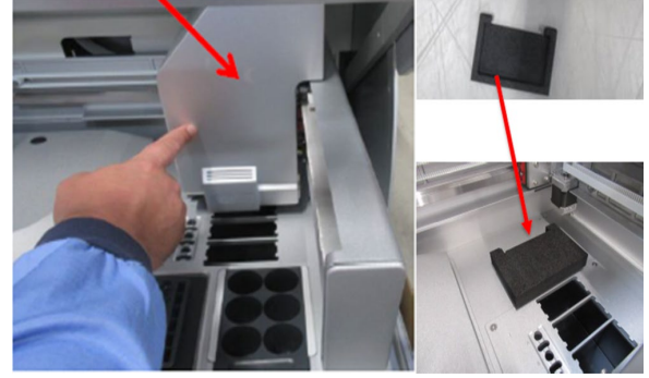
Robotik kolların altındaki köpük koruyucu.
