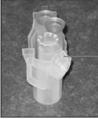
1,5 mL'lik mikrosantrifüj tüpü kapağı, rotor adaptörünün yanlış yuvasında
