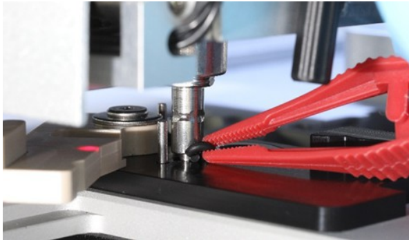
Gri kolu açın ve O halkasını cımbızı kullanarak çıkarın.
