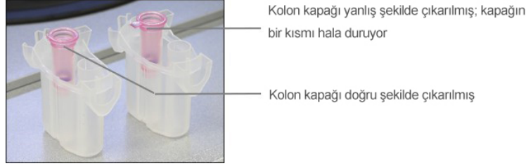
Doğru ve yanlış şekilde çıkarılmış kolon kapaklarının karşılaştırması.
