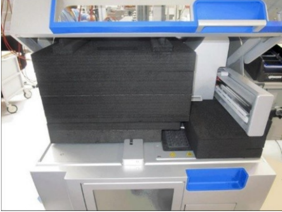
Santrifüj üzerindeki köpük koruyucu.
