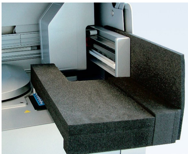
Protetor de espuma inserido entre a centrífuga e o braço robótico.
