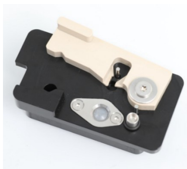
Ferramenta para anel de vedação com novo anel de vedação preparado.
