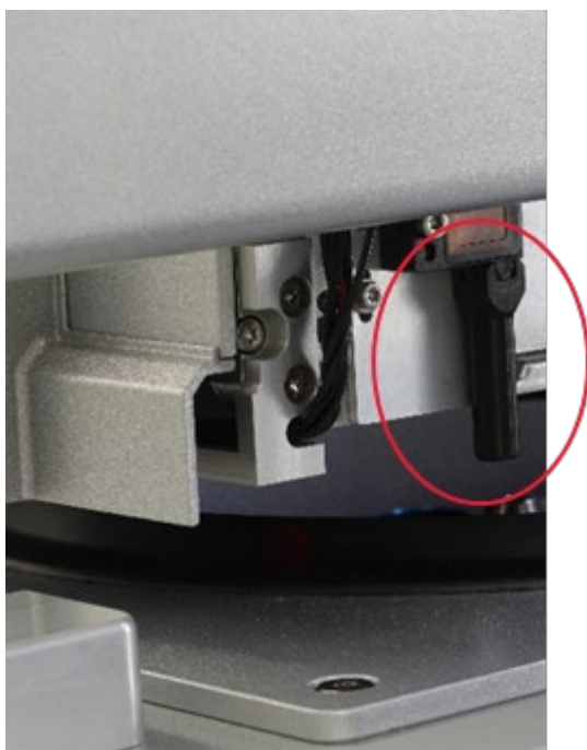
Colimador de feixe preto (veja o círculo vermelho) do sensor ultrassônico.
