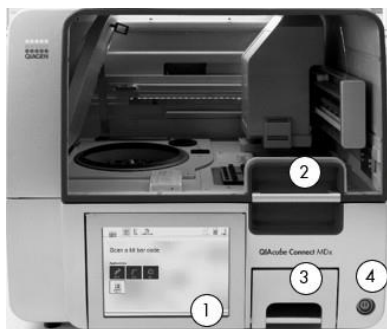
Vedere din față a QIAcube Connect MDx
