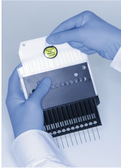
図 4. QX Cartridge Stand にセットした QIAxcel Gel Cartridge
