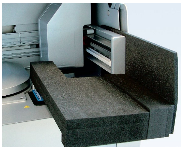
Skumbeskyttelse satt inn mellom sentrifugen og robotarmen.
