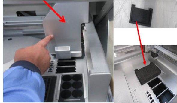
Pelindung busa di bawah lengan robotik.
