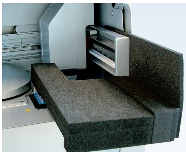
Pelindung busa yang disisipkan antara alat sentrifugasi dan lengan robotik.
