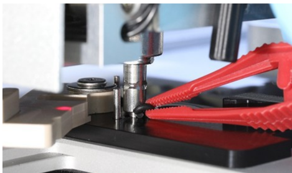
Buka tuas abu-abu dan lepaskan Ring-O menggunakan pinset.
