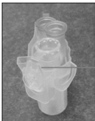
Adaptateur de rotor chargé de façon incorrecte. C Adaptateur de rotor chargé de façon incorrecte avec un tube de microcentrifugation de 1,5 ml. Le bouchon n'est pas abaissé à fond dans le logement de l'adaptateur de rotor et pourrait se désolidariser en cours de centrifugation (comparé à la situation A sur la figure précédente); D Adaptateur de rotor chargé de façon incorrecte vue de côté (comparé à la situation B sur la figure précédente).
