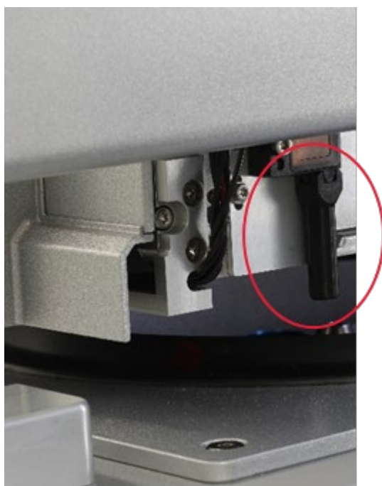
Collimateur d'orientation du faisceau noir (entouré en rouge) du capteur ultrasonore.
