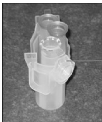
Bouchon du tube de microcentrifugation de 1,5 ml dans le mauvais logement de l'adaptateur de rotor
