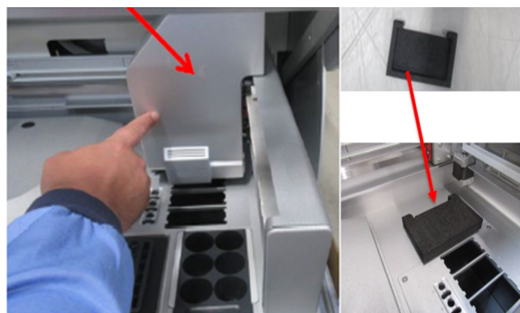
Mousse de protection sous les bras robot.
