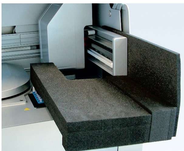
Mousse de protection insérée entre la centrifugeuse et le bras robot.
