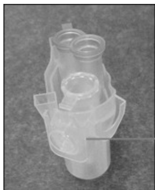
Adaptateur de rotor correctement chargé. A Adaptateur de rotor correctement chargé et bouchon du tube de microcentrifugation de 1,5 ml dans la bonne position. B Adaptateur de rotor correctement chargé vu de côté.
