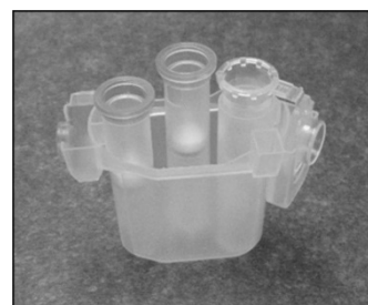
Adaptateur de rotor correctement chargé. A Adaptateur de rotor correctement chargé et bouchon du tube de microcentrifugation de 1,5 ml dans la bonne position. B Adaptateur de rotor correctement chargé vu de côté.
