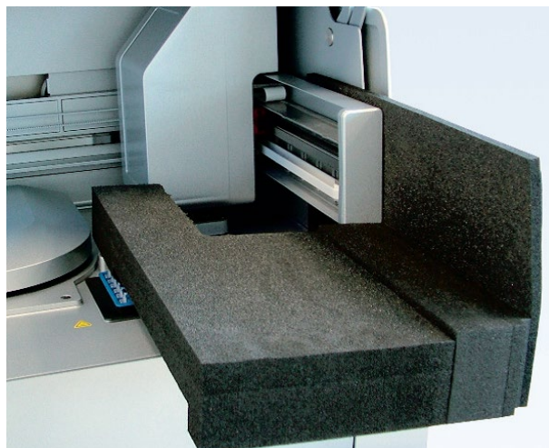
Zwischen der Zentrifuge und dem Roboterarm eingesetzter Schaumstoffschutz.
