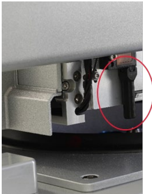
Schwarzer Strahlenkollimator (siehe roter Kreis) des Ultraschallsensors.
