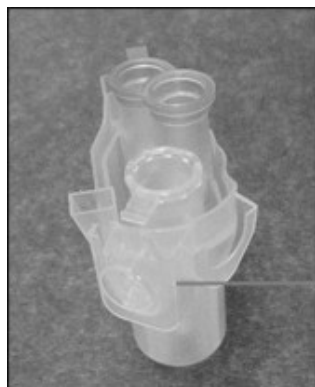
Korrekt beladener Rotoradapter. A Rotoradapter ist korrekt geladen, und der Deckel des 1,5-ml-Mikrozentrifugenröhrchens befindet sich in der richtigen Position. B Korrekt beladener Rotoradapter, von der Seite betrachtet.
