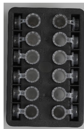
Deckel der Probenröhren müssen fest in die Schlitz an den Seiten des Schüttlergestells gesetzt werden.
