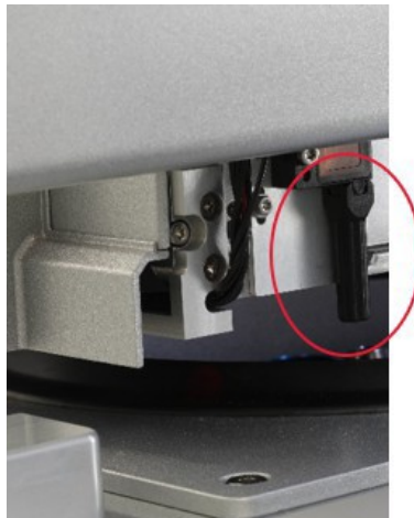
Schwarzer Strahlenkollimator (siehe roter Kreis) des Ultraschallsensors.
