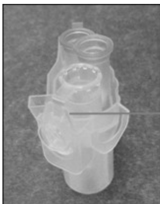
Inkorrekt beladener Rotoradapter. C Rotoradapter ist inkorrekt mit einem 1,5-ml-Mikrozentrifugenröhrchen beladen. Der Deckel des Röhrchens ist nicht bis ganz nach unten in den Schlitz des Rotoradapters geschoben worden und könnte während der Zentrifugation abbrechen (vergleichen Sie mit Teil A der obigen Abbildung); D inkorrekt beladener Rotoradapter, von der Seite betrachtet (vergleichen Sie mit Teil B der obigen Abbildung).
