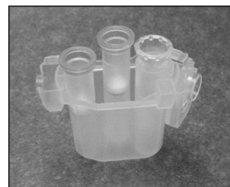
Korrekt beladener Rotoradapter. A Rotoradapter ist korrekt geladen, und der Deckel des 1,5-ml-Mikrozentrifugenröhrchens befindet sich in der richtigen Position. B Korrekt beladener Rotoradapter, von der Seite betrachtet.
