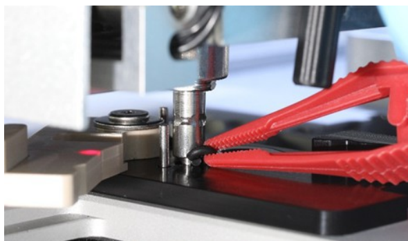
Öffnen des grauen Hebels und Entfernen des O-Rings mithilfe der Pinzette.
