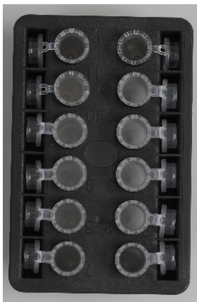
Veká na skúmavkách na vzorky musia byť bezpečne vložené do otvorov na okraji stojana trepačky.
