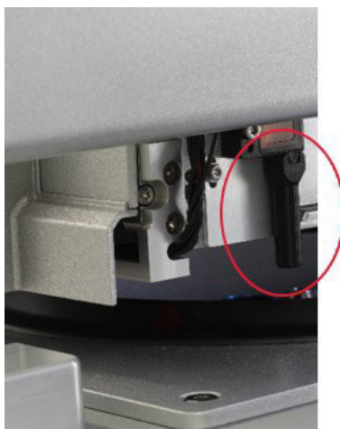
Čierny kolimátor zväzku (pozri červený krúžok) ultrazvukového senzora.
