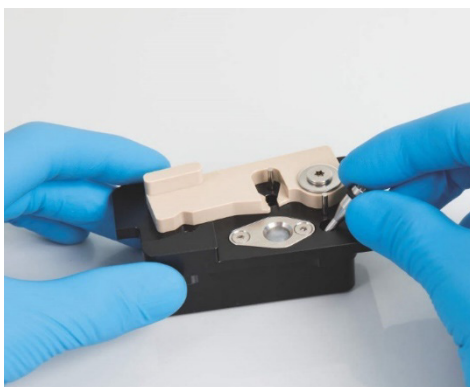
Zatlačte kolík nadol pomocou zadného konca pinzety.
