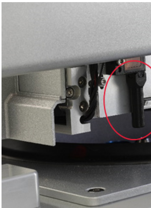
Čierny kolimátor zväzku (pozri červený krúžok) ultrazvukového senzora.
