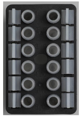
Do otvorov na okraji stojana trepačky je nutné vložiť zátky stojana trepačky.
