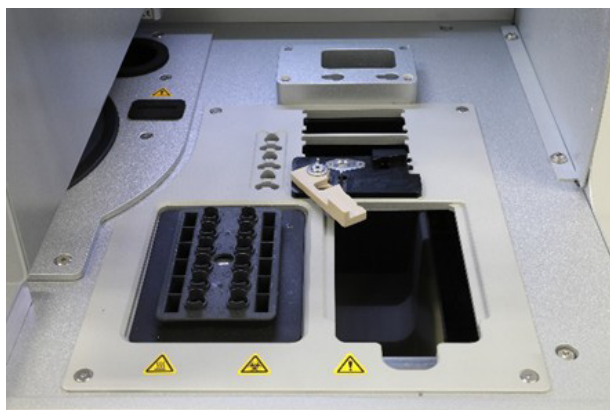
Загрузка инструмента для замены уплотнительного кольца
