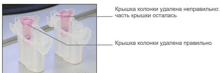
Сравнение правильно и неправильно удаленных крышек колонки
