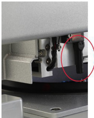
Черный звуковод (отмечен красной окружностью) ультразвукового датчика
