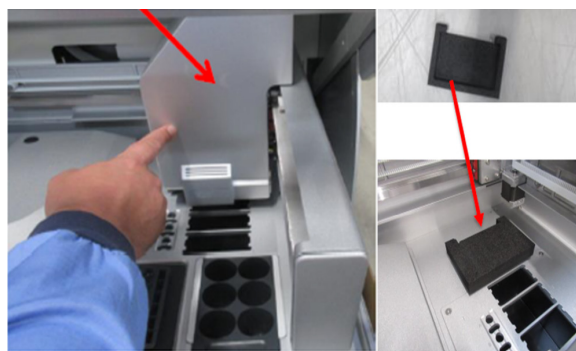
Пенопластовая защита под манипулятором
