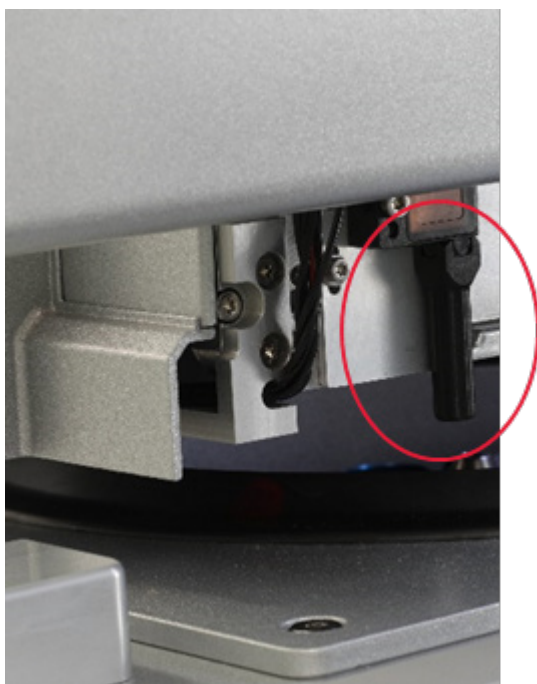
Черный звуковод (отмечен красной окружностью) ультразвукового датчика
