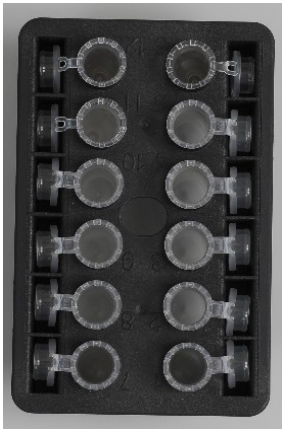
Крышки пробирок с образцами должны быть надежно размещены в гнездах по краю штатива шейкера
