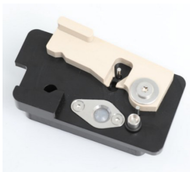
Инструмент для замены уплотнительного кольца с новым уплотнительным кольцом
