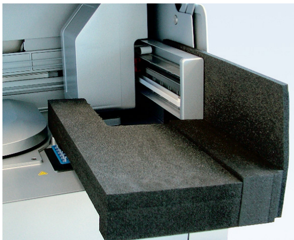
Пенопластовая защита вставлена между центрифугой и манипулятором
