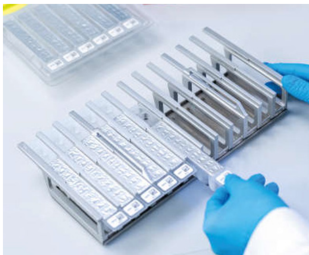
Joonis 3. Reaktiivikassetide alus. Kassetialusel on nool, mis näitab, millises suunas reaktiivikassetid (RCV) tuleb laadida.
