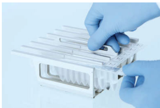
Joonis 9. Reaktiivikassetide aluse laadimine. Kassetialusel on nool, mis näitab, millises suunas reaktiivikassetid (RCV) tuleb laadida.
