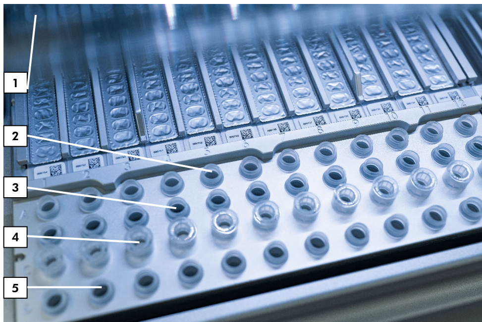
Joonis 5. Seadme EZ2 Connect MDx röölaud. (1) Lüüsimiseks mõeldud reaktiivikassetitesse (RCV) laaditud 2 ml katsutitega (ST) kuumutusplokk. (2) Proovikatsutid (ST) (2 ml) on laaditud ritta A. (3) Katsuti (ET) (1,5 ml), mis sisaldab elueerimispuhveris (AVE) kandur-RNA-d (KANDUR) ja sisemist kontrolli (IC) (kui seda kasutatakse), on laaditud ritta B. (4) Ühekordsed otsikuhoidjad (DTH), mis sisaldavad ühekordseid filtritsikuid (DFT), on laaditud ritta C. (5) Elueerimiskatsutid (ET) (1,5 ml) on laaditud ritta D.
