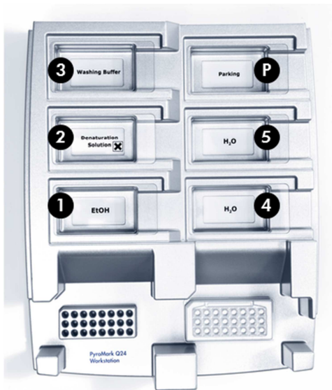
Bild 3. Placering av PCR-platta och PyroMark Q24-platta på vakuumstationen.
