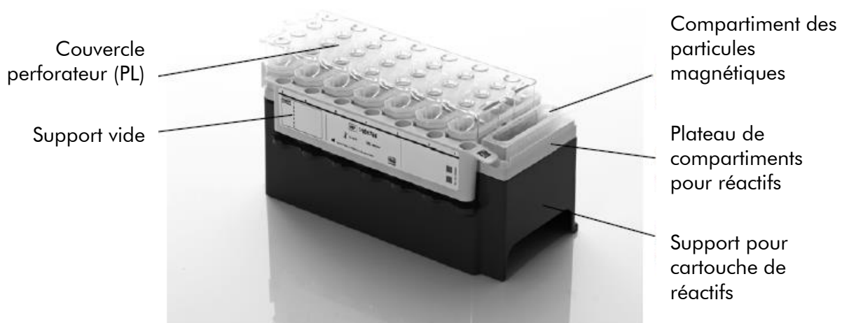
Figure 2. Cartouche de réactifs QIASymphony (RC). La cartouche contient tous les réactifs nécessaires au cycle du protocole.
