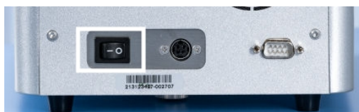
Figure 5. Emplacement de l'interrupteur d'alimentation (mis en évidence par un encadré blanc).
