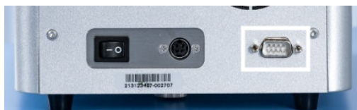
Figure 7. Emplacement du port du lecteur de codes-barres (mis en évidence par un encadré blanc).
