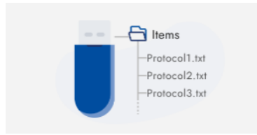
Figure 34. Structure des dossiers de la clé USB pour le chargement du protocole. Tous les protocoles à charger sur le QIAmini doivent être situés dans un dossier nommé Items.
