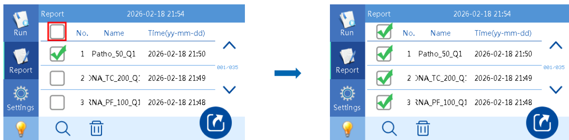
Figure 55. Menu Report du QIAmini – sélection du ou des rapports. La case à cocher mise en évidence par le rectangle rouge permet de sélectionner tous les rapports en une seule fois.
