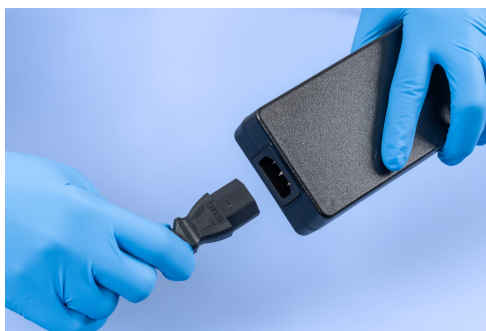
Figure 16. Branchement du cordon d'alimentation du QIAmini sur le bloc d'alimentation.
