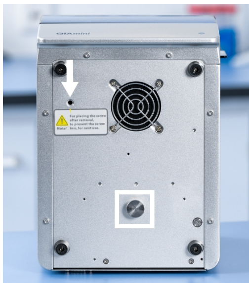
Figure 15. Emplacement de la vis de blocage pour le transport (mise en évidence par un encadré blanc) et de la position de rangement (indiquée par une flèche blanche) sur la face inférieure du QIAmini.
