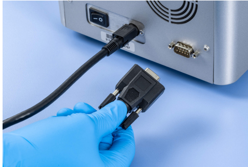
Figure 18. Connexion du lecteur de codes-barres au port RS232.
