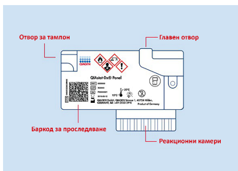
Фигура 1. Конфигурация на QIAstat-Dx Respiratory SARS-CoV-2 Panel Cartridge и нейните компоненти.
