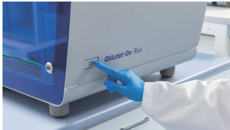
Kuva 5. QIAstat-Dx Rise -järjestelmän ON/OFF-painike.
