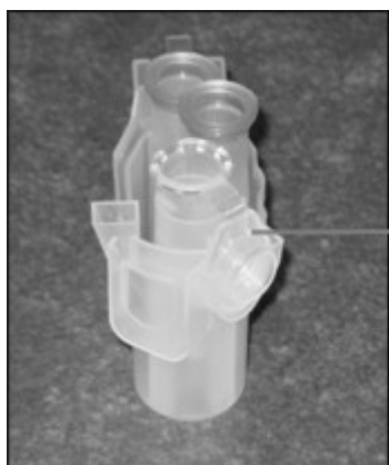
1,5 ml mikrocentrifūgas stobriņa vāciņš ir nepareizā rotora adaptera spraugā
