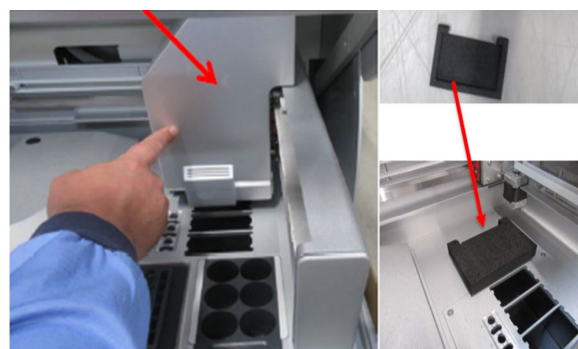
Putuplasta aizsargmateriāls zem robotizētajām svirām.
