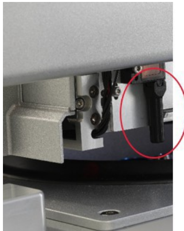
Ultraskaņas sensora melnā staru kūļa kolimators (skatiet sarkanajā aplī).
