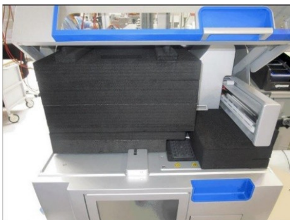
Putuplasta aizsargmateriāls virs centrifūgas.
