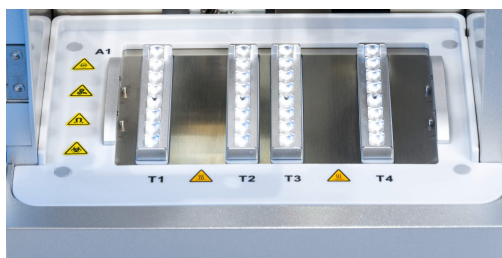
Figura 9. El bloque calefactor del QIAmini consta de cuatro filas (T1, T2, T3 y T4).
