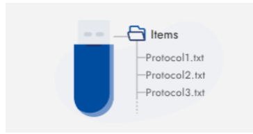
Figura 34. Estructura de carpetas de la unidad USB para cargar protocolos. Todos los protocolos que se vayan a cargar en el QIAmini deben estar ubicados en una carpeta llamada items.
