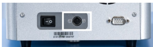
Figura 6. Ubicación de la toma del cable de alimentación (resaltada con un marco blanco).
