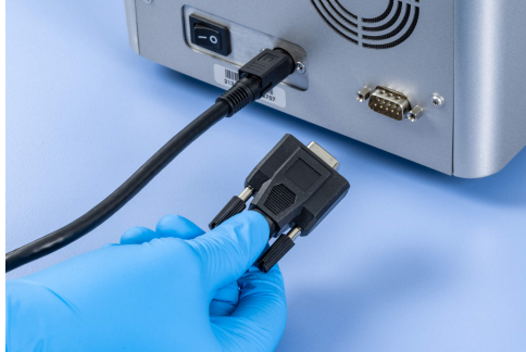
Figura 18. Conexión del lector de códigos de barras al puerto RS232.
