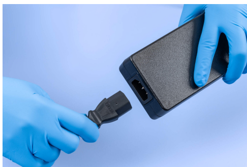
Figura 16. Conexión del cable de alimentación del QIAmini a la fuente de alimentación.
