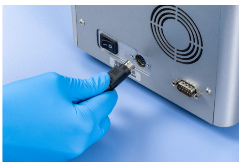
Figura 17. Conexión de la fuente de alimentación del QIAmini al instrumento.
