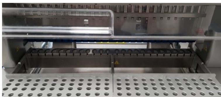
Figura 15. Gradillas de puntas en el interior del instrumento.
