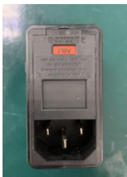
Figura 8. Variante alternativa del conector de alimentación con la indicación de 230 V.
