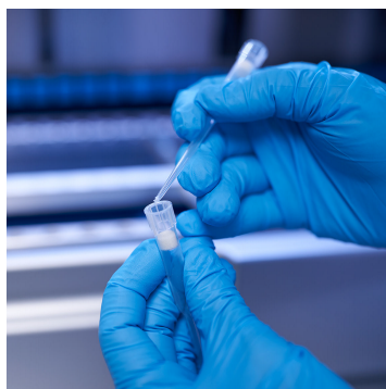
Figura 181. Preparación de las puntas con filtro para la aplicación de lubricante.
