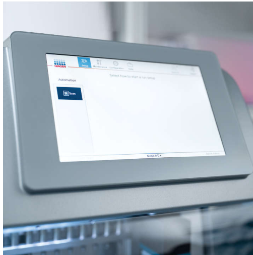
Figura 3. Pantalla táctil del EZ2 Connect MDx con interfaz gráfica de usuario (GUI).
