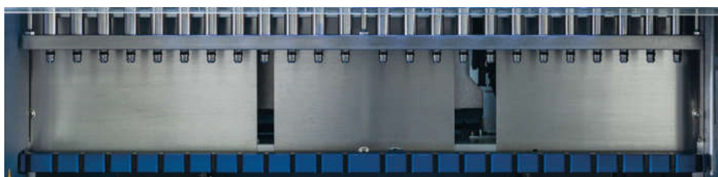
Figura 10. Cabezal de pipeteo del EZ2 Connect MDx.
