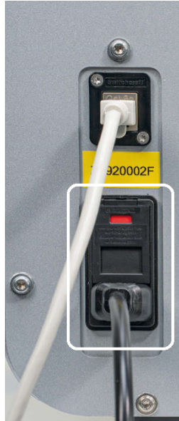
Figura 7. Ubicación del conector del cable de alimentación (marcado con un marco blanco).
