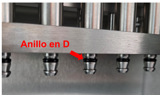
Figura 179. Adaptador de punta con anillo en D resaltado.
