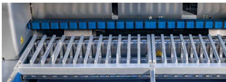
Figura 12. Gradilla de cartuchos extraíble en el instrumento.
