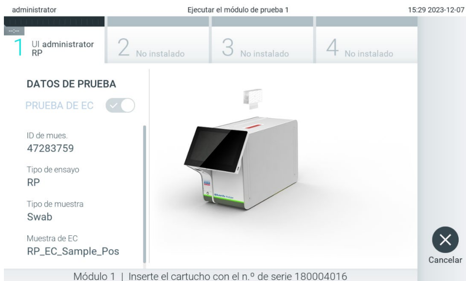
Figura 97. Introducción del cartucho de ensayo QIAstat-Dx en el dispositivo QIAstat-Dx Analyzer 2.0.
