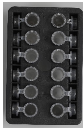
Locken på rören måste placeras säkert i skårorna i kanten av skakapparatstället.
