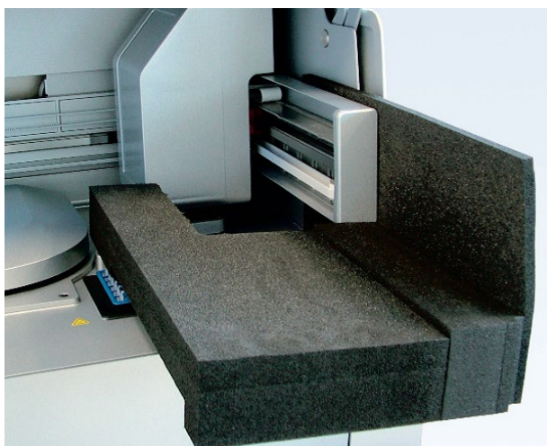
Skumskyddet har placerats mellan centrifugen och robotarmen.
