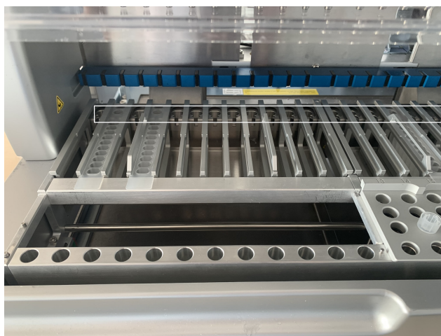
Abbildung 17. Heatable positions in the cartridge rack (highlighted by white frame). (Beheizbare Positionen im Kartuschenrack (weiß umrandet))
