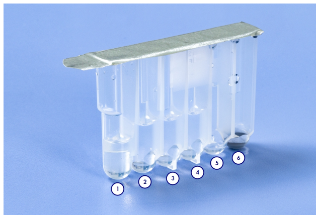
Abbildung 11. Vorgefüllte QIAmini-Kartusche (Vertiefungen 1 bis 6, von links nach rechts).
