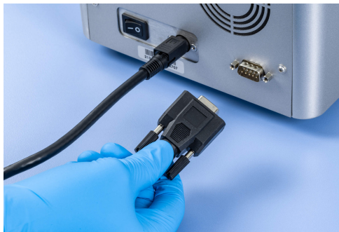
Abbildung 18. Anschließen des Barcode-Scanners an den RS232-Anschluss.
