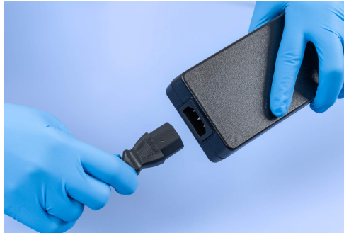
Abbildung 16. Verbinden Sie das Netzkabel des QIAmini mit dem Netzteil.
