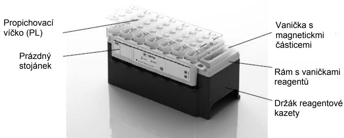
Obr 2. QIAAsymphony reagentová kazeta (RC). Reagentová kazeta (RC) obsahuje všechny reagenty pro běh protokolu.
