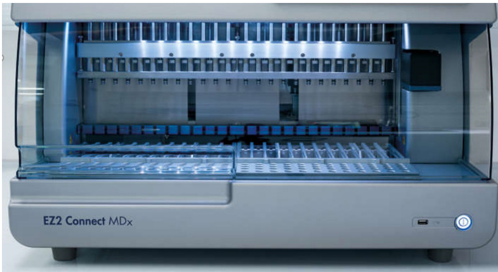
그림 4. 후드가 닫힌 EZ2 Connect MDx.
