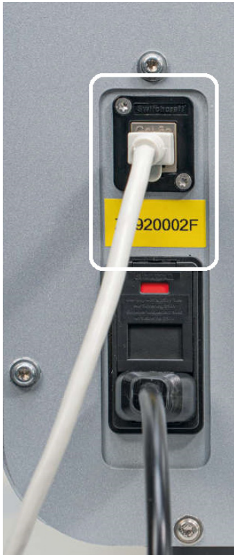
그림 6. RJ-45 포트 위치(흰색 테두리로 강조 표시됨).
