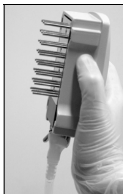
Rycina 4. Ilustracja przedstawiająca narzędzie próżniowe uniesione pionowo o kąt przekraczający 90°.
