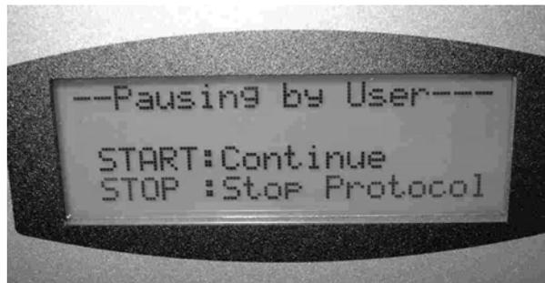
2. Um den Protokolldurchlauf fortzusetzen, drücken Sie die „START“-Taste.
