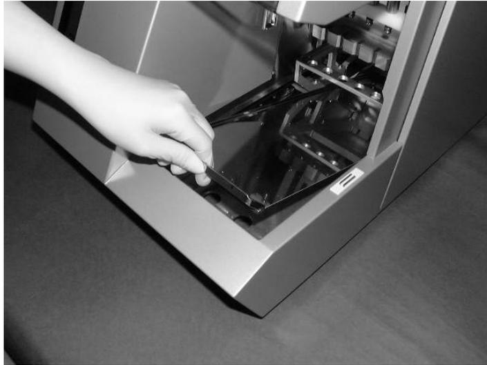
Verfahren Sie in umgekehrter Reihenfolge, um die Auffangschale wieder einzusetzen. Vergewissern Sie sich, dass die Schale korrekt positioniert ist, um einen eventuellen Geräteschaden zu vermeiden.
