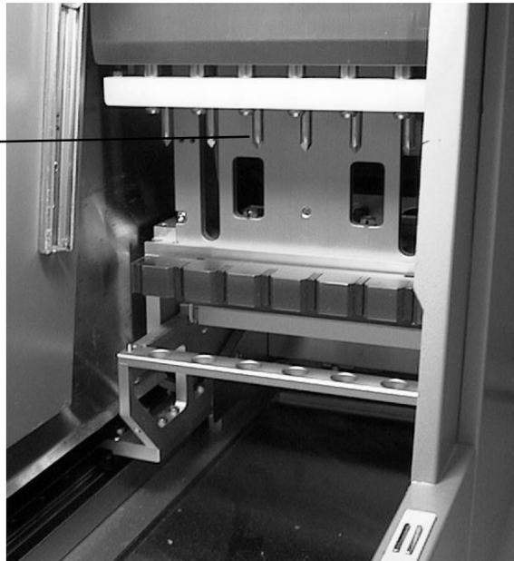
5. Wischen Sie die Durchstech-Einheit mit einem weichen, mit destilliertem Wasser angefeuchteten Papiertuch ab.
