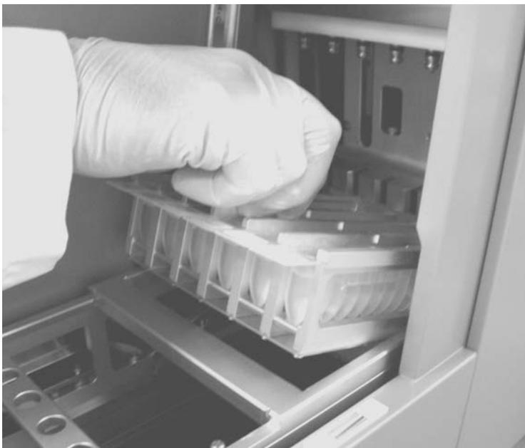
Vergewissern Sie sich, dass sich die beiden temperierbaren Positionen jeder Kartusche im Heizsystem befinden.
