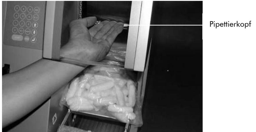
4. Entfernen Sie den Beutel mit dem Schaumstoff-Verpackungsmaterial.
