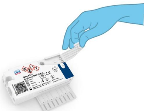
**Figure 39. Ouverture du couvercle du port principal.**
