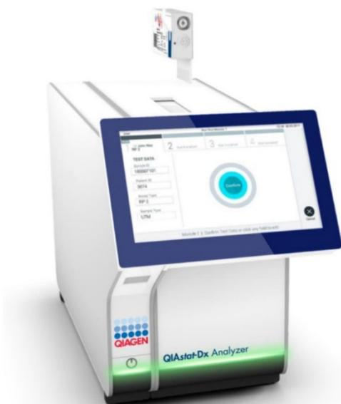
**Figure 48.** Insertion de la QIAstat-Dx Respiratory SARS-CoV-2 Panel Cartridge dans le QIAstat-Dx Analyzer 1.0 ou le QIAstat-Dx Analyzer 2.0.
