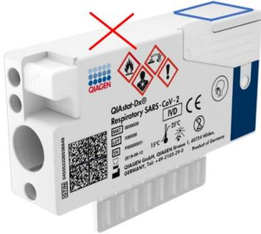
Figure 19. Positionnement du code-barres de l'ID de l'échantillon.
