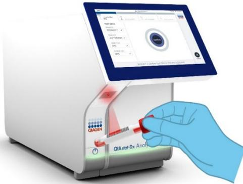
**Figure 44. Lecture du code-barres de l'identifiant d'échantillon.**
