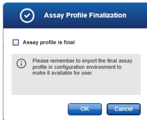
L'utilisateur doit cocher la case « Assay profile is final » (Le profil d'essai est terminé). Seuls les profils d'essai avec cette option cochée peuvent être importés dans l'environnement « Configuration » (Configuration) pour une utilisation ultérieure.
