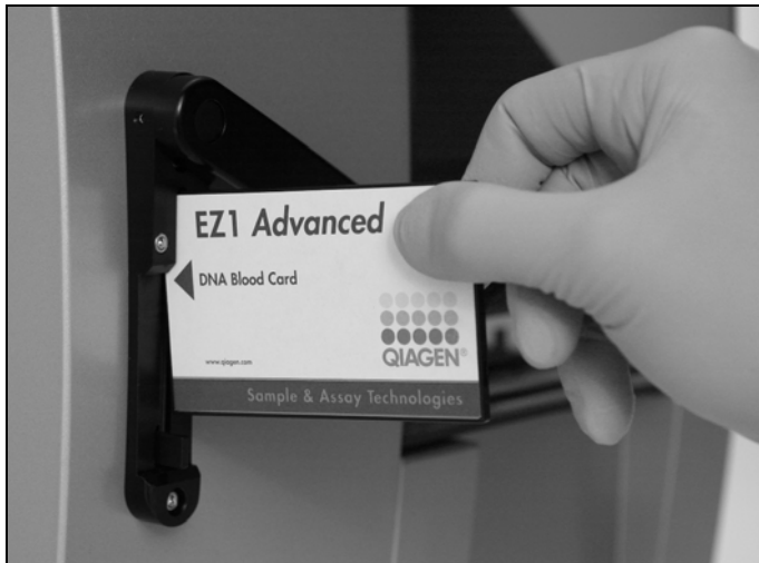
Figura 6. Facilidade de configuração do protocolo utilizando os cartões EZ1. Inserção de um cartão EZ1, contendo o protocolo, no EZ1 Advanced.
