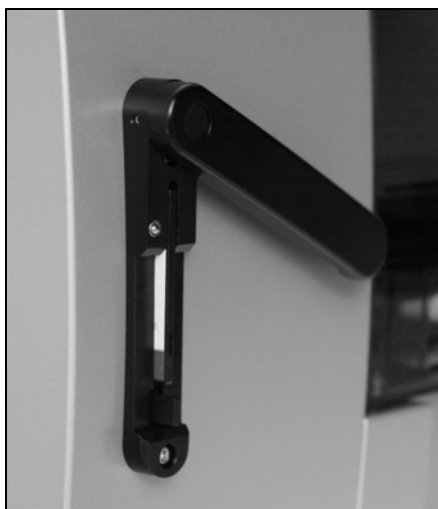
Figura 7. Cartão EZ1 totalmente inserido na respectiva ranhura.
