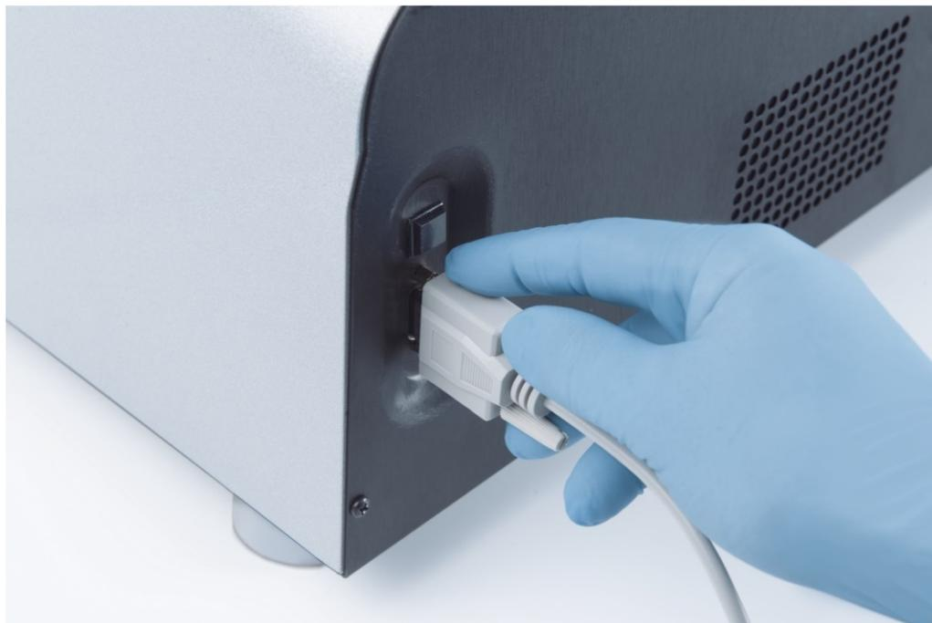
5. Conecte el otro extremo del cable RS-232 al puerto serie del PC del sistema HC2 y apriete los tornillos de bloqueo.
