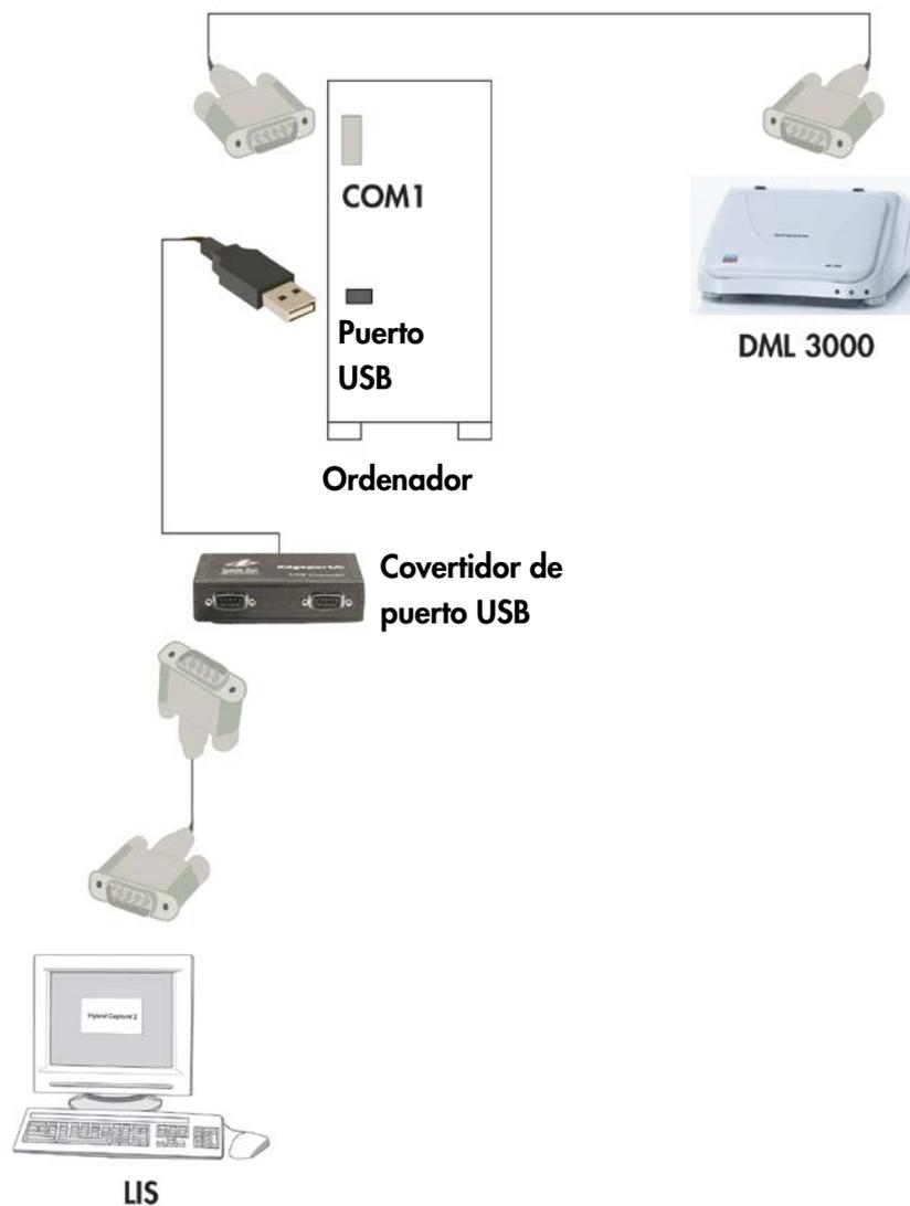
Diagrama de conexión de un DML 3000 con un RCS y un LIS:
