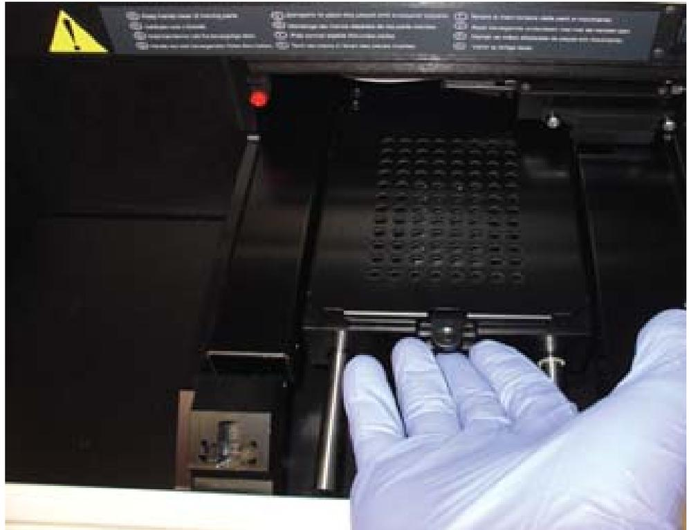
5. Partiendo de la posición inicial, empuje suavemente el cabezal óptico hacia el centro del instrumento.
