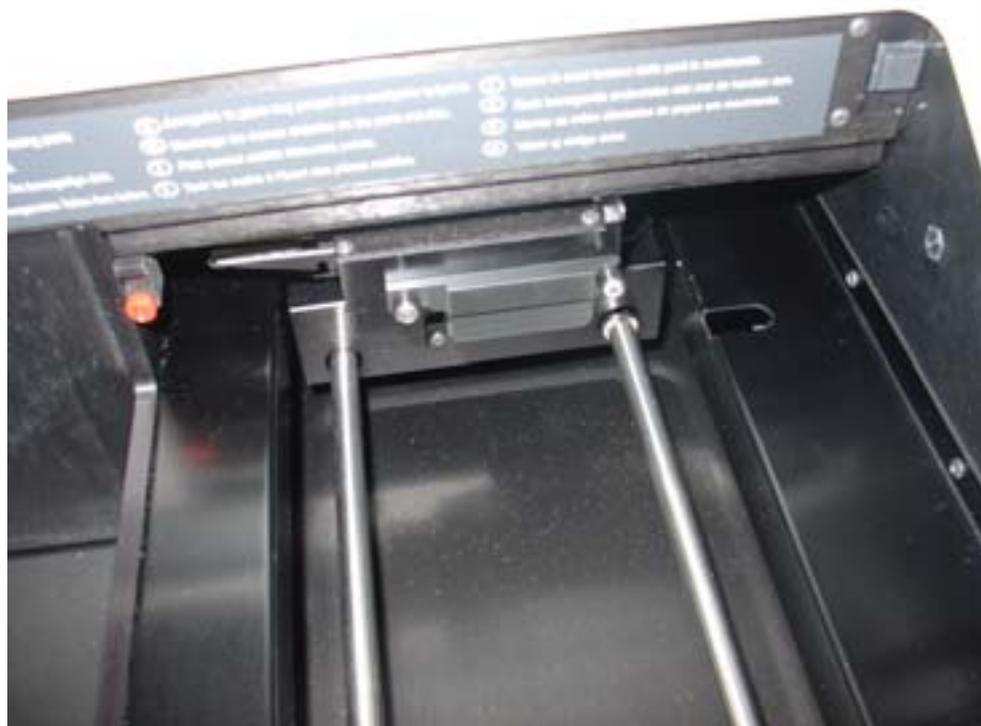
6. Presione hacia arriba el lado izquierdo del retenedor de la máscara óptica para desengancharlo del perno izquierdo y, a continuación, tire del retenedor hacia la izquierda para desengancharlo del perno derecho.
