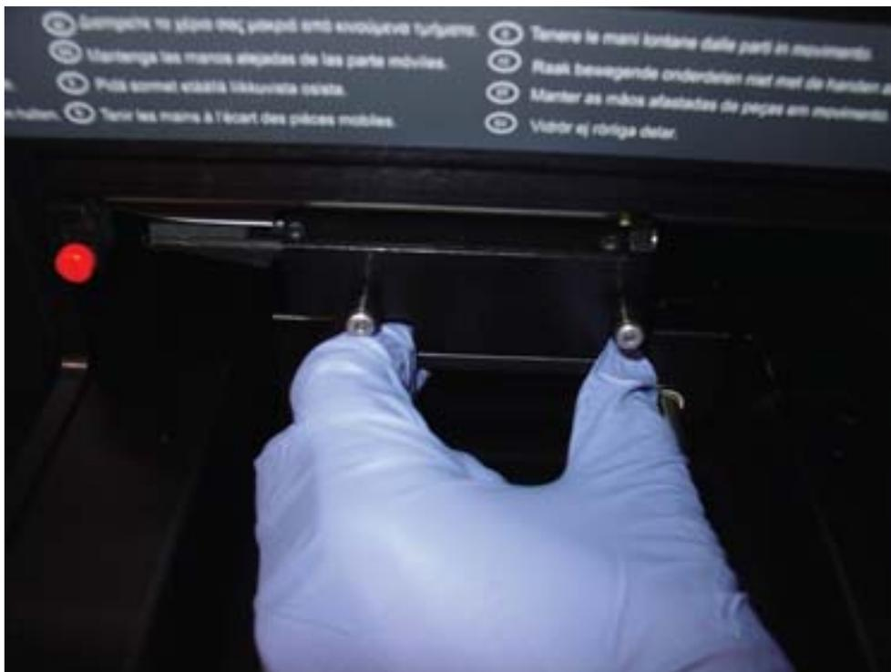
8. Limpie la máscara óptica y el retenedor de la máscara óptica con una toalla de papel que suelte poca pelusa humedecida con alcohol isopropílico al 70%.
