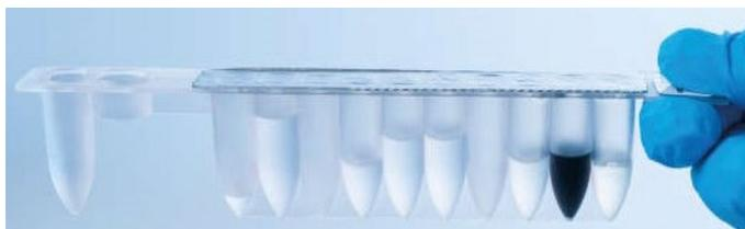
**Figura 2. Cartucho de reactivos (RCV).** Cartucho de reactivos (RVC) prerrelleno y sellado del EZ1 DSP Virus Kit.
