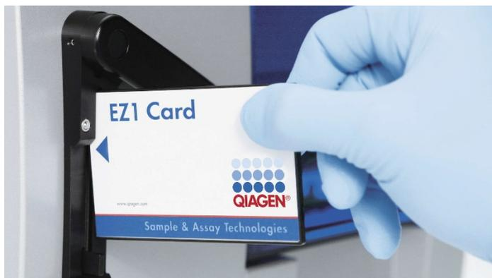
**Figura 6. Facilidad para configurar un protocolo con las tarjetas EZ1 DSP Cards.** Se inserta una tarjeta EZ1 Card, preprogramada con el protocolo, en el instrumento EZ1.
