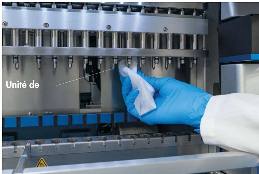
Figure 127. Nettoyage de l'unité de perforation de l'instrument EZ2.
