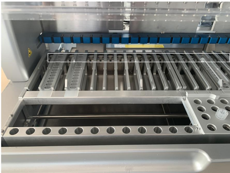
Figure 15. Positions chauffantes dans le portoir à cartouches (mises en évidence d'un cadre blanc).
