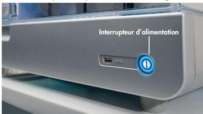
Figure 21. Emplacement de l'interrupteur d'alimentation.
