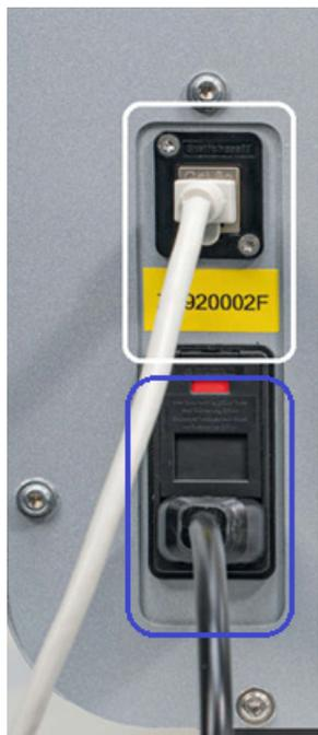
Figure 6. Emplacement du port RJ-45 (blanc) et de la prise du cordon d'alimentation (bleu).
