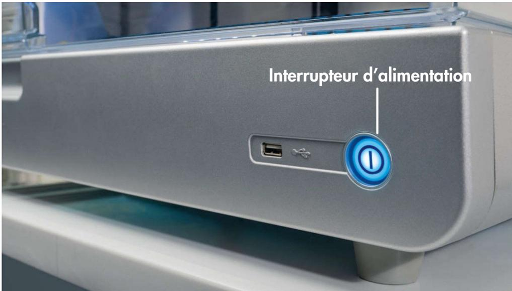
Figure 5. Emplacement de l'interrupteur d'alimentation.
