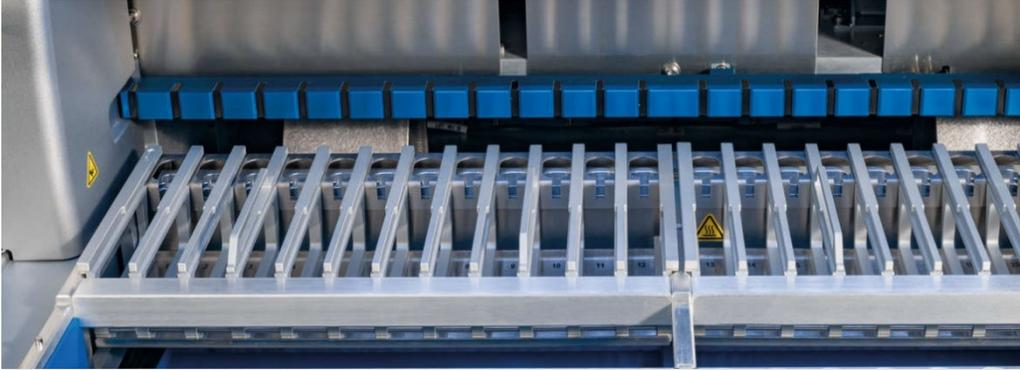
Figure 10. Portoir à cartouches à l'intérieur de l'instrument.
