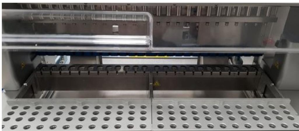
Figure 13. Portoirs à pointes dans l'instrument.
